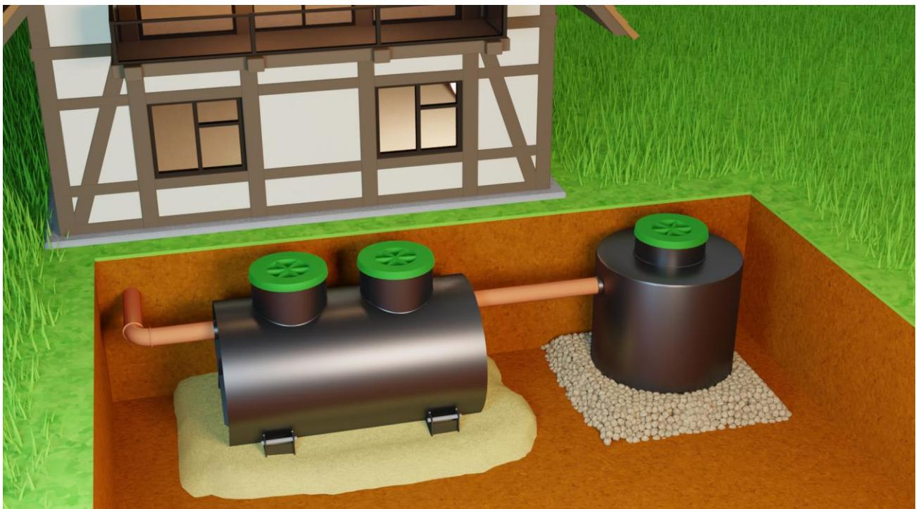
**Вариант 2.** Монтаж станции «Диамант» в грунты с низким коэффициентом фильтрации (суглинок, глина).
