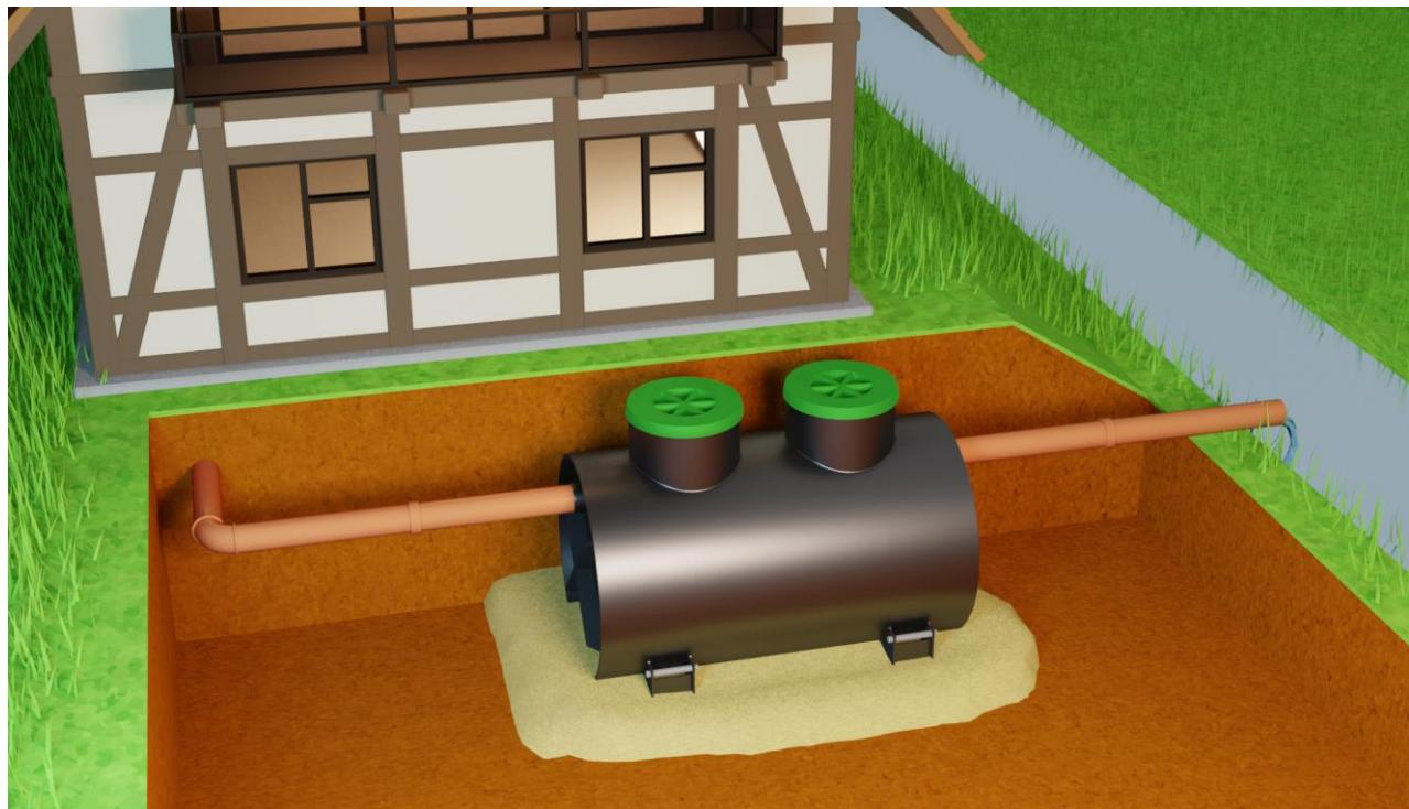
**Вариант 3.** Монтаж установки «Диамант» при глубине залегания выходной сточной трубы более 1м.
