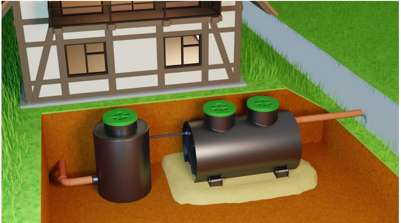
**Вариант 4.** Монтаж станции «Диамант» при невозможности отвода очищенной сточной воды самотеком.
